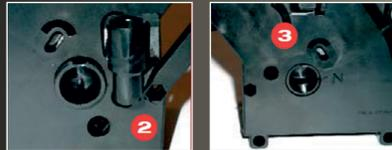
Der Wassereinflaufstutzen muss senkrecht stehen Pos.2. Auf der gegenüberliegenden Seite müssen sich die beiden Pfeile – mit einem „N“ gekennzeichnet – gegenüberstehen Pos.3.
