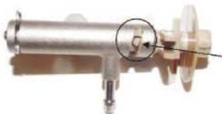
Ancien robinet avec arbre et broche en plastique.
